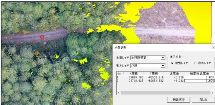
(2) 指定した箇所の比高差を確認し、補正後比高差を入力すると比高差が調整されます。
