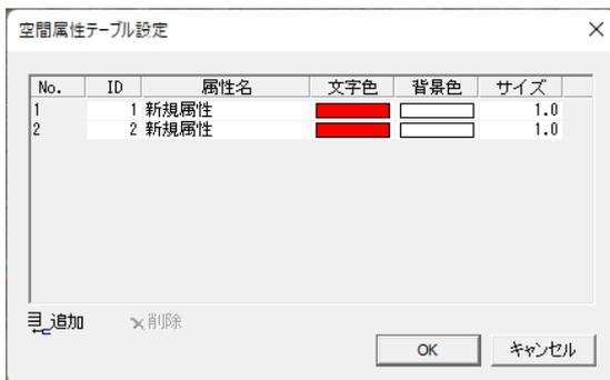
(2) 「属性>空間属性>追加/削除」をオンにし、断面間隔を入れて横断線（基線）を作成します。
