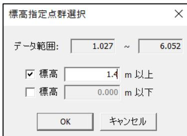
(3) 選択点を削除する事により道路面のみ残すことができます。
